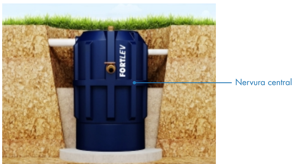
Figura 7 – Aterro com compactação até o início da nervura central.
