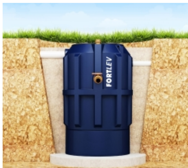
Figura 8 – Aterro completo com compactação.
